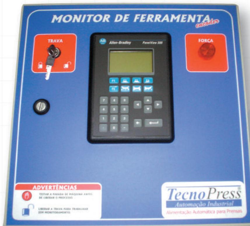
Este sistema tem por finalidade o monitoramento do processo de estampagem em prensa de freio-fricção. Nos processos onde a alimentação do material é automática, ou seja, sem a manipulação do operador, o monitor de ferramenta protege o estampo no caso de erro no posicionamento do material, bem como falha na saída de peça e enrugamento da tira, entre outros pontos críticos.
